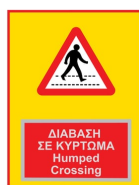
Υπερυψωμένη διάβαση πεζών Humped pedestrian crossing
