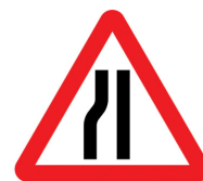
Ο δρόμος στενεύει από την αριστερή πλευρά Road narrows on the left
